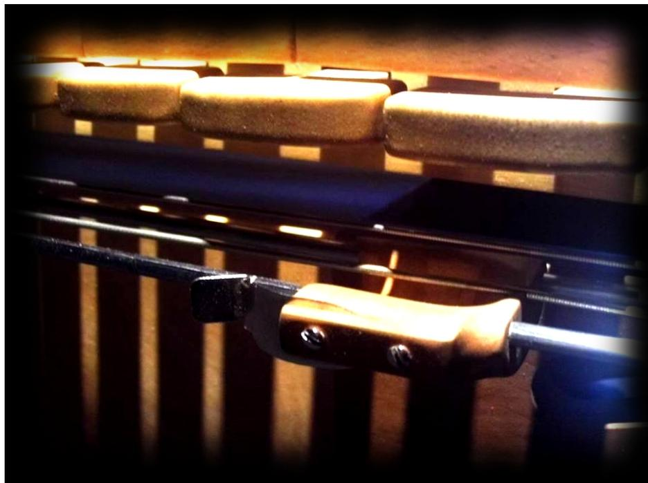
Système de capodastre coulissant sur deux tringles. L'une d'elles est pourvue d'un ou plusieurs jeux d'encoches permettant de passer rapidement d'une note à l'autre sans ré-accordage. Il est possible de passer d'un jeux d'encoche à l'autre (ou sans encoche) en faisant tourner la tringle.
